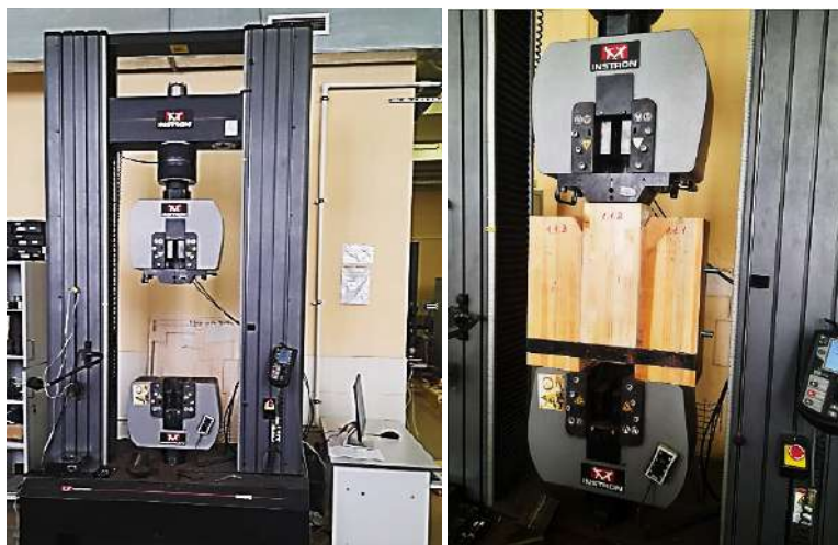
Рис. 2. Испытательная машина «Инстрон 5989» с установленным для испытания образцом
