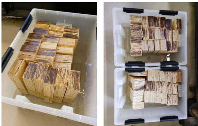
Рис. 3. Процесс вымачивания элементов соединения для достижения 15 % влажности
