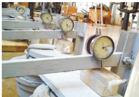
Рис. 4. Проведение испытаний LVL -древесины на длительную прочность треугольными штампами с разной высотой [7]
