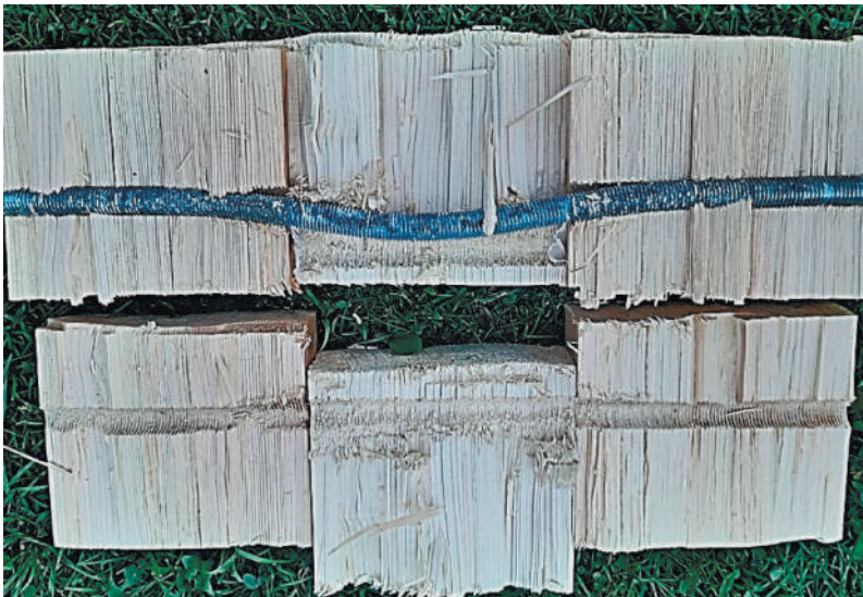
Рис. 5. Вскрытие нагельного гнезда первой группы испытания (нагель-шпилька с резьбой по всей длине)
