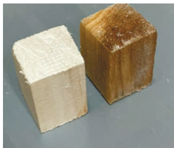
Рис. 1. Стандартные образцы для испытания на сжатие (без модификации и с модификацией)
