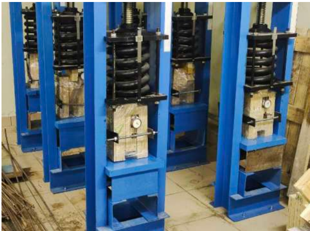
Рис. 4. Длительные испытания нагельных соединений с когтевыми шайбами
