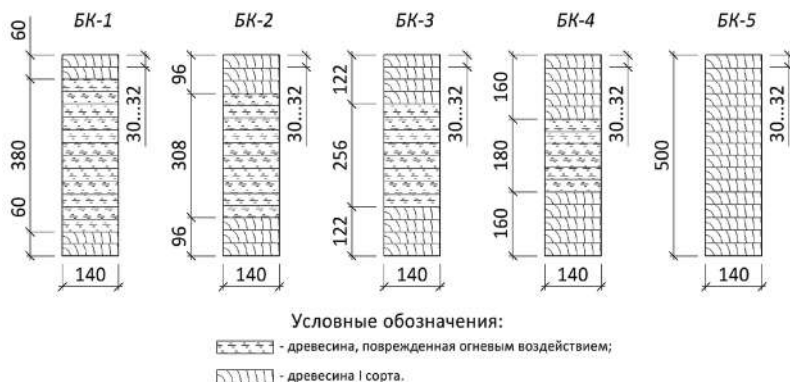
Рис. 2. Сечения исследуемых балок БК-1...БК-5
