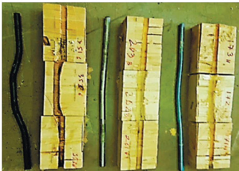
Рис. 4. Вскрытые нагельные гнезда
