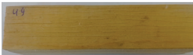
Рис. 4. Трещины после 2-го цикла замачивания
